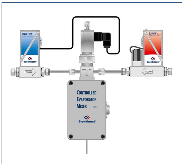
单载气供应，无稀释，热式液体流量计(MFM)
